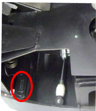
PLAQUETA DE Nº DE SÉRIE DO CHASSI Abrir a porta e verificar a plaqueta no canto inferior esquerdo.
