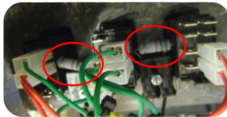
1 resistência de 220 OHMS entre cada botão
